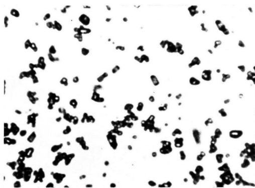
Abb. 2. ZnS-Luminophor. Mineralisiert bei 1200 °C, getempert bei 800 °C (Vergr. 225 ×).
